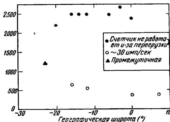
Рис. 5. График, характеризующий работу газоразрядного счетчика в экваториальных районах на разных высотах
